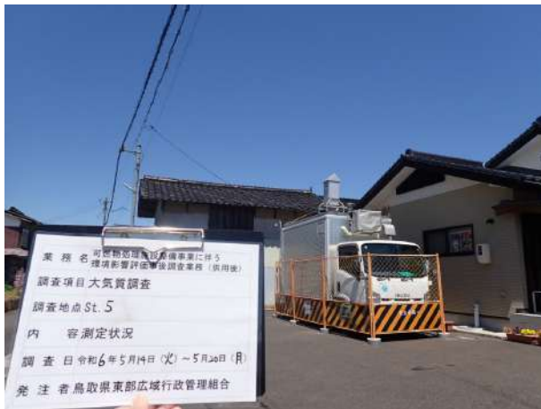
大気質調査(測定車による調査)
