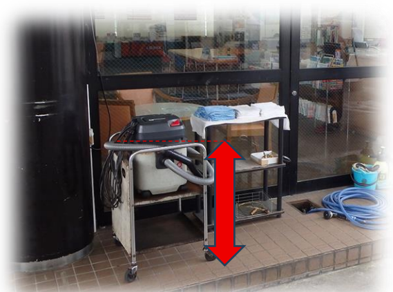
防爆構造ではないコードリールや掃除機を嵩上げて使用している様子 地盤面から0.6m以上の高さが必要なのは、コードリールは接続部分、掃除機はモーター部分です
