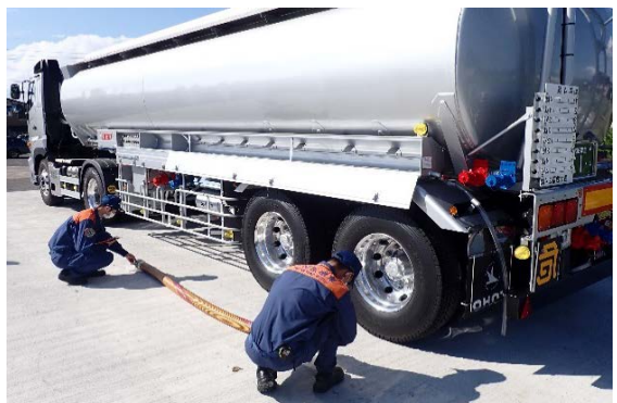
移動タンク貯蔵所完成検査
