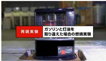
この実験は、故意に燃料タンクにガソリンを給油して着火した際の映像です。
